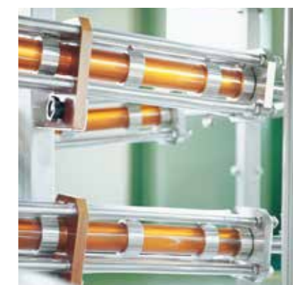
固形物(最大20mm) 入り液体製品から高粘性製品 60~95(30秒保持)~10℃
